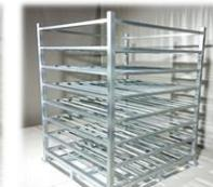
収納する商品の大きさ、冷蔵倉庫の高さにより棚高、段数、全高を決定できます。
