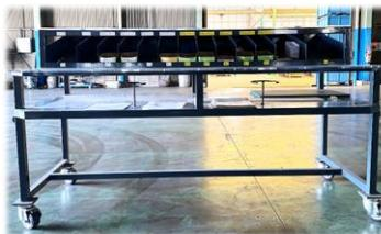
工場内でボルトを梱包するための専用台車です。
