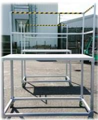
トラックの長手方向に横付けして使用する作業台です。
